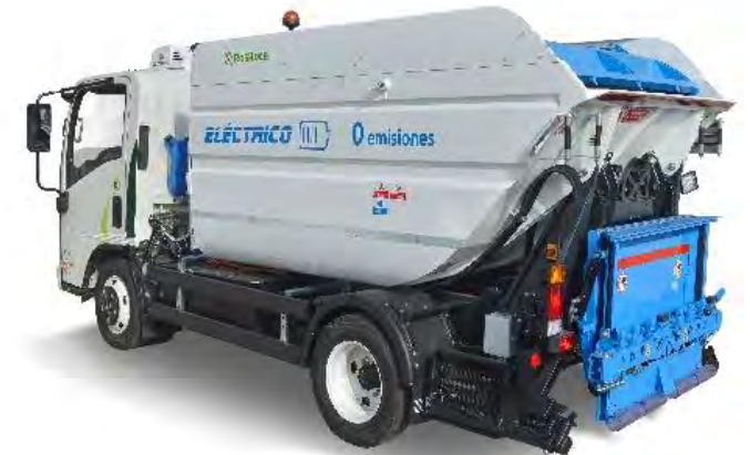
Recol·lector satèl·lit elèctric
