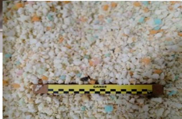
Espumas flexibles de PUR post-consumo procedentes de una planta de tratamiento integral de voluminosos, principalmente de colchones que han llegado al final de su vida útil
