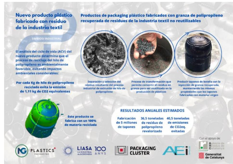
**LIASA** ha fabricado un nuevo producto plástico fabricado con residuo textil. Es un packaging plástico fabricado con granza de polipropileno, cada Kg de hilo reciclado evita la emisión de 1,11kg de CO2 equivalentes. Se estima una revalorización del residuo de polipropileno de 36,5 toneladas al año, lo que significaría evitar 40,5 toneladas de emisiones de CO2 eq.
