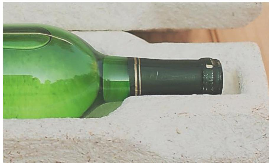
Ecovative ha diseñado un material a base de subproductos agrícolas y micelios que sustituye al EPS (poliestireno expandido) para fabricar envases utilizando una alternativa renovable y compostable.
